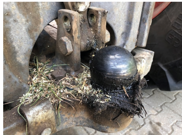
Beim Anhängen ist Hygiene gefragt! Um Verschleiss zu vermeiden, sollten alle Teile der Kugelkupplung gründlich von Schmutz und altem Schmierfett gereinigt werden.
