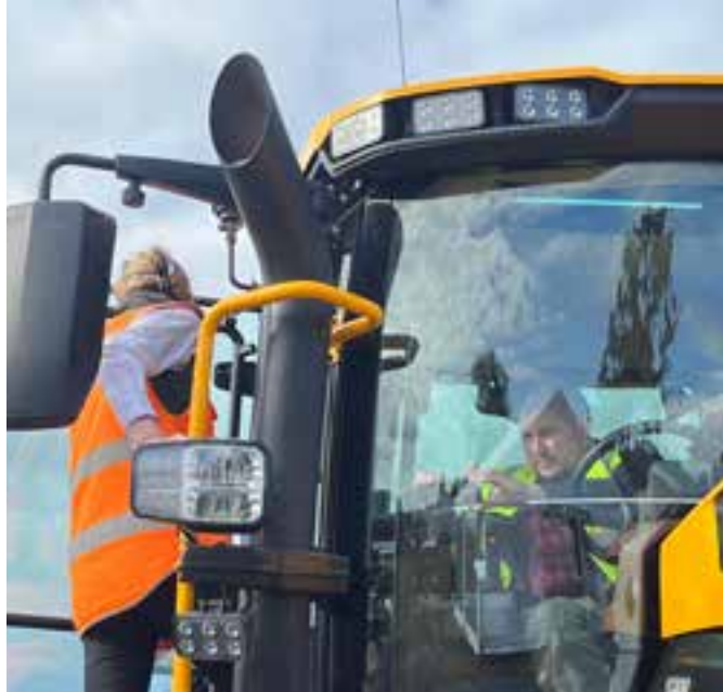
Die LED-Beleuchtung ermöglicht maximal 48'000 lm und eine Ausleuchtung bis zu 360°.
