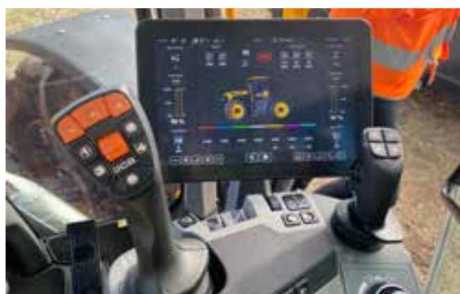
Das Bedienkonzept iCON bietet konfigurierbare Touchscreen-Displays, und es kann ein weiterer Monitor positioniert werden.
