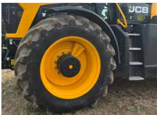
Neu ist eine ab Werk integrierte Reifendruckregelanlage als Einleiter-System. Zwei per Keilriemen angetriebene Kompressoren liefern die Luft. Die angesaugte Luft wird gekühlt und gefiltert.
