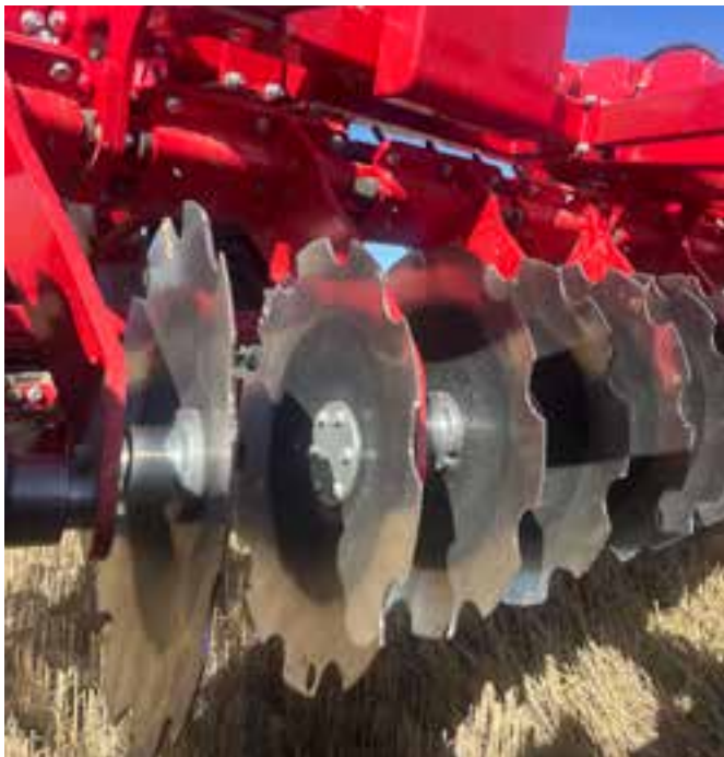
Die gezahnten Scheiben mit einem Durchmesser von 62 cm bewirken ein intensives Einmischen von zähem Material.
