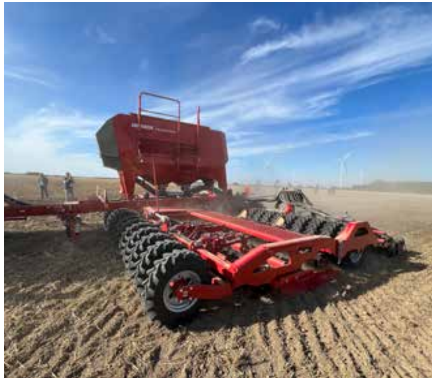
Das G&F-Doppeltanksystem erlaubt die gleichzeitige Ausbringung auf einem Horizont.
